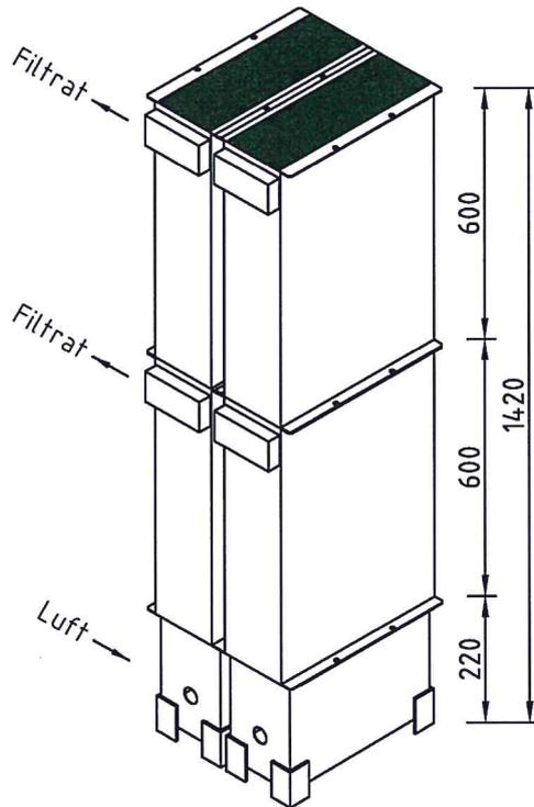
Kleinkläranlagen mit Abwasserbelüftung zur Freiaufstellung Typ BUSSE MF – HKA und Typ BUSSE MF – G-HKA für 4 bis 50 EW, Ablaufklasse N+H
