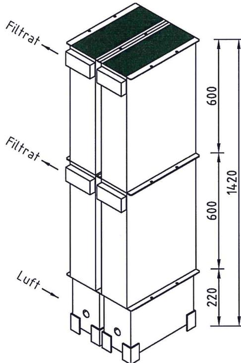
Kleinkläranlagen mit Abwasserbelüftung zur Freiaufstellung Typ BUSSE MF – HKA und Typ BUSSE MF – G-HKA für 4 bis 50 EW, Ablaufklasse D+H
