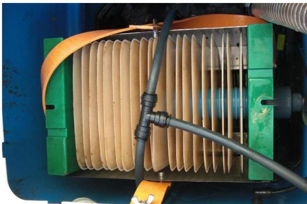
Belebungsstank mit eingebautem Membranfilter
