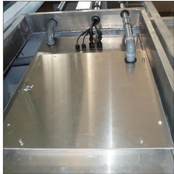
... und geschlossen, mit Leitungen zur Membranstufe im zweiten Schwimmkörper.
